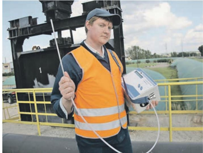
Вчера 11:25 Инженер-химик Алексей Уваров с газоанализатором ГАНК, который фиксирует с высочайшей точностью наличие в воздухе вредных примесей
